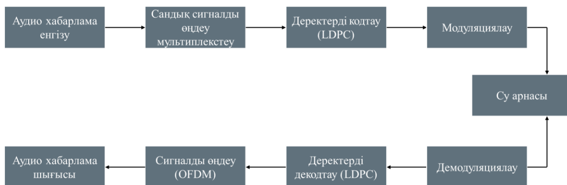
4.2-сурет – Li-Fi технологиясының көмегімен дауыстық хабар тарату коммуникациясының негізгі байланыс сұлбасы
